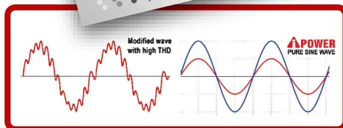
Svi A-iPower inverterski generatori imaju čisti sinusni izlaz različitih kapaciteta za opskrbu SVIH vrsta čak i osjetljivih uređaja s THD manjim od 3%.
